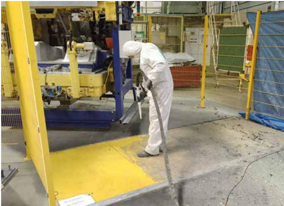
Verschmutzte Oberflächen können mit Hilfe von Trockeneis schonend gereinigt werden.
