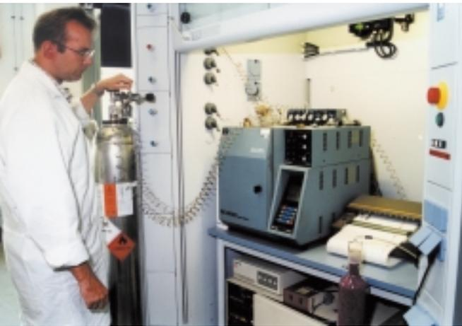
Prüfgastest am Gaschromatografen im Spezialgaswerk in Krefeld-Gellep
