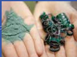
Optimiertes Recycling von Verbundwerkstoffen durch Kaltmahlen mit Stickstoff
