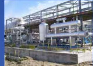
Moderne CO<sub>2</sub>-Verflüssigungsanlage im belgischen Zwijndrecht, die rund 20 Tonnen CO<sub>2</sub> pro Stunde aus Industrieabluft zurückgewinnt.
