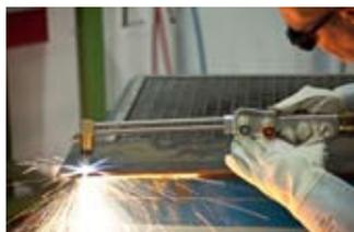
Der Hand-Schneidbrenner ESSEN zum Brennschneiden bis 500 mm Materialstärke und zum Fugenhobeln
